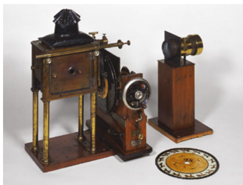
Ryc. 14 Zoopraksiskop – urządzenie opracowane przez Muybridge'a do wyświetlania ruchomych obrazów, 1879–1885
