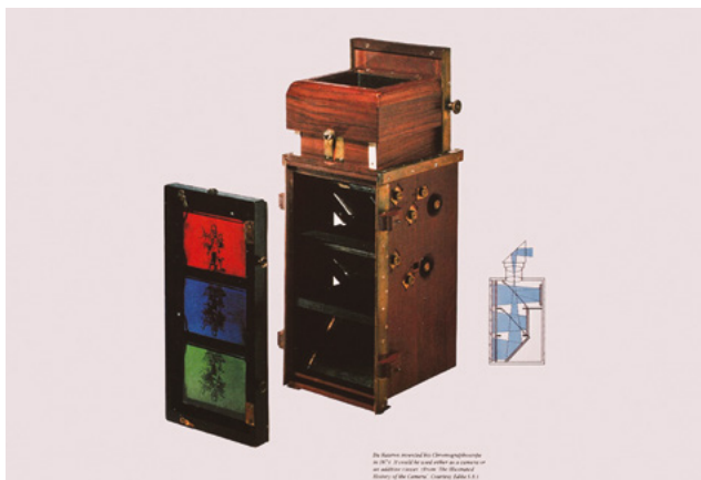
Ryc. 11 Chromografoskop Louisa Ducosa du Haurona z 1874 roku. Może być używany jako aparat fotograficzny lub projektor
